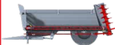
Aandrijflijn met overbrenging onder de verlaagde as (ideaal voor hellingen).
